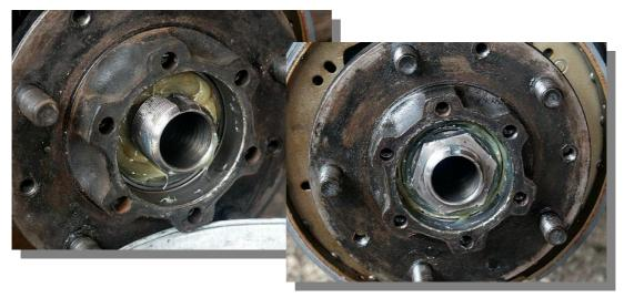
die Einstellmutter aufschrauben. Den Bremsennachsteller ganz zurückdrehen und die gereinigte und entfettete Bremstrommel aufschieben. Diese mit den drei Schlitzschrauben an der Radnabe befestigen.
