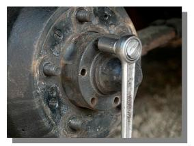
Anschließend das Rad entfernen. Jetzt werden die 6 Schrauben mit den Federscheiben aus dem Mitnehmer herausgeschraubt. Wichtig: eine Schale oder ähnliches unterstellen, da trotz der Schräglage des Wagens noch einiges an Öl herausläuft.
