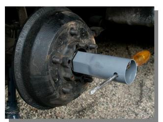
Sicherungsblech jedoch das zwischen Nabenmutter und Einstellmutter zurückgebogen werden.
